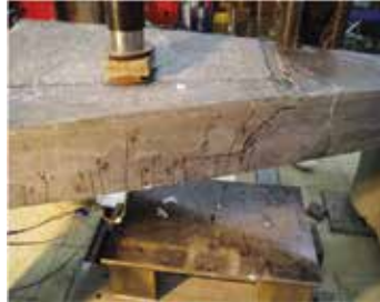
Распределение трещин в ребре образца
