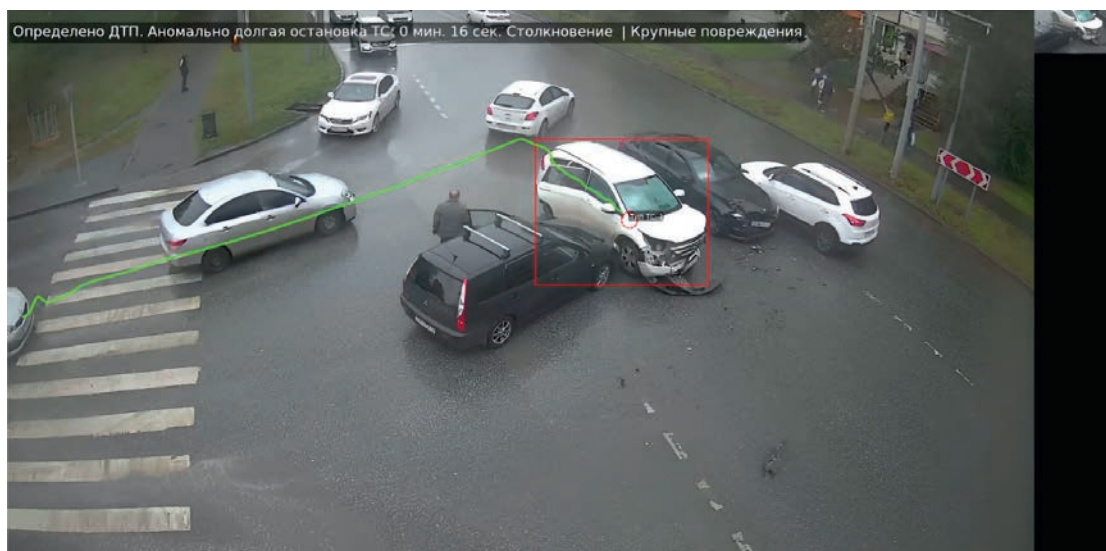
Рис. 1. Использование компьютерного зрения и ИИ для фиксирования ДТП
